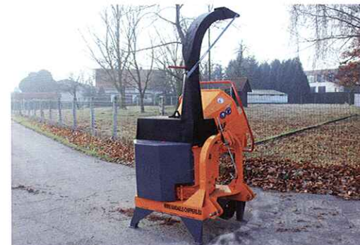
TVI6-22 PT ; optionele 270° draaibare uitvoering voor driepuntsversie
